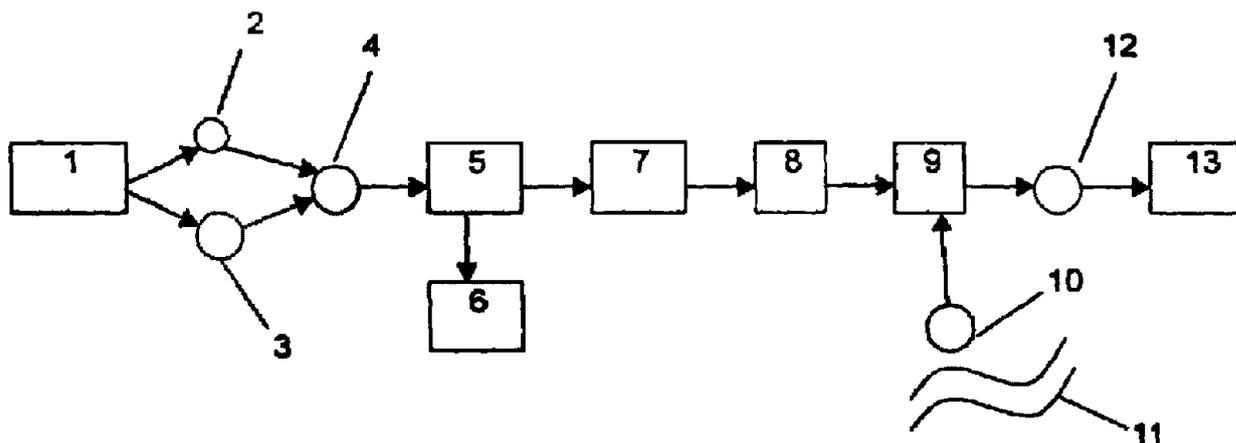
Рисунок 1 - Технологическая линия подготовки, хранения и использования стоков:
