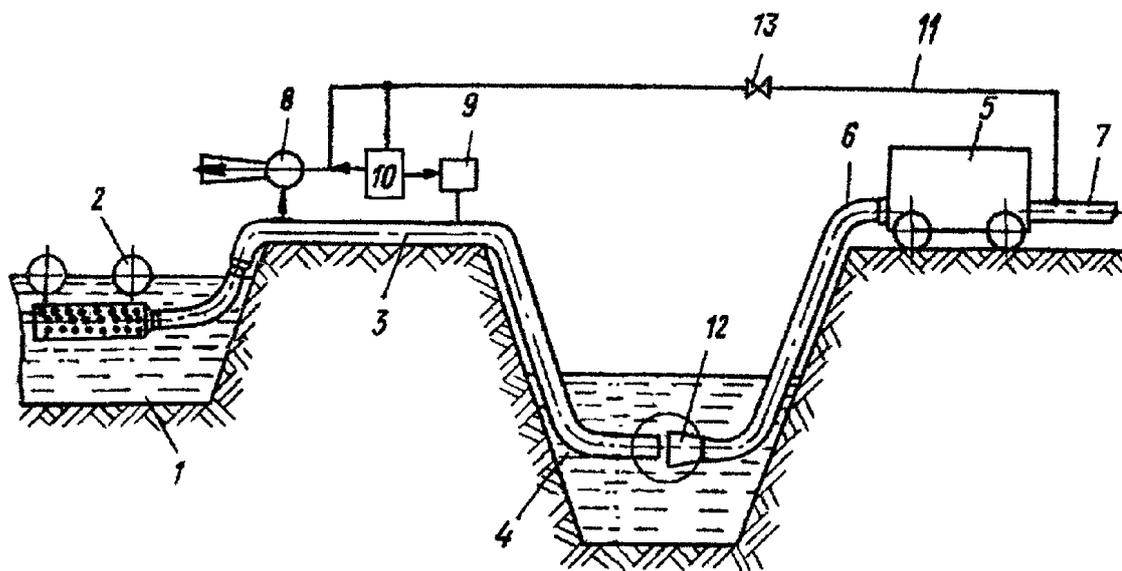
Рисунок Л.2 - Сифонно-импульсный ввод стоков в оросительную сеть:
