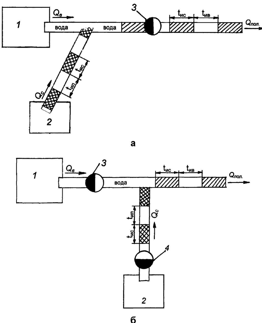
Рисунок Л.1 - Схемы импульсного ввода стоков в оросительную сеть:
