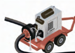
5. Дизельная насосная станция (бустерная)
