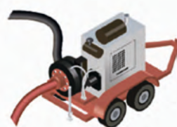
4. Дизельная насосная станция (основная)
