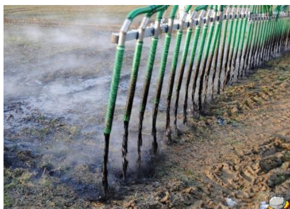
Рисунок 2.71 – Поверхностное внесение жидкого органического удобрения через распределитель с системой навесных шлангов
