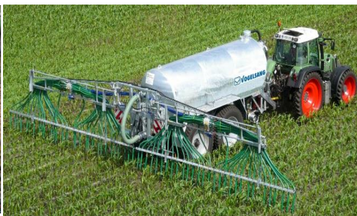
Рисунок 2.71 – Поверхностное внесение жидкого органического удобрения через распределитель с системой навесных шлангов
