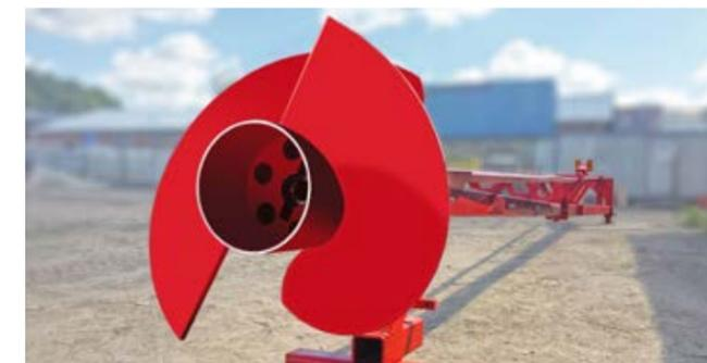
**Лагунный миксер навесной (винт или шнек) 10,5 м** - механическое перемешивающее устройство
