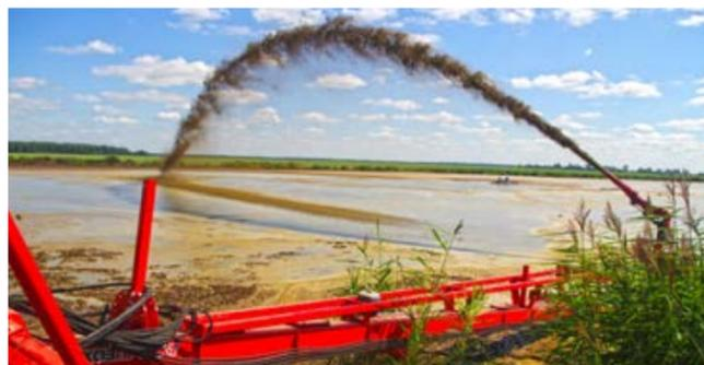
**Лагунная помпа прицепная 15,5 м; 20 м** – струйное, циркулярное перемешивающее устройство на технологическом (выдвижном, откидывающемся) шасси, позволяющем транспортировку и безопасный (плавный) спуск в любую лагуну.
